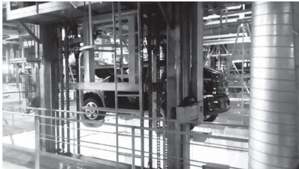
S자동차회사의 D/L에 슈퍼체인 使用 例 An example that S motor company uses Super Chain on D/L
