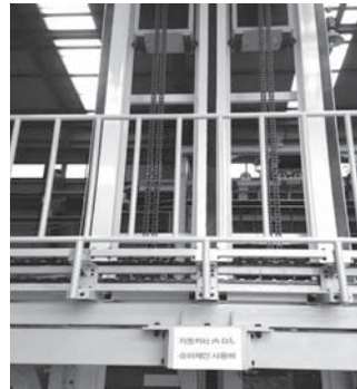
K자동차회사의 D/L에 슈퍼체인 使用 例 An example that K motor company uses Super Chain on D/L
